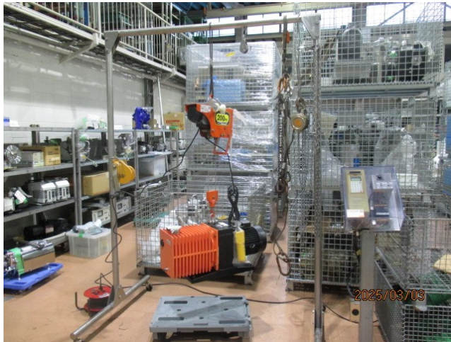
約100Kgの真空ポンプの吊り下げテスト中
